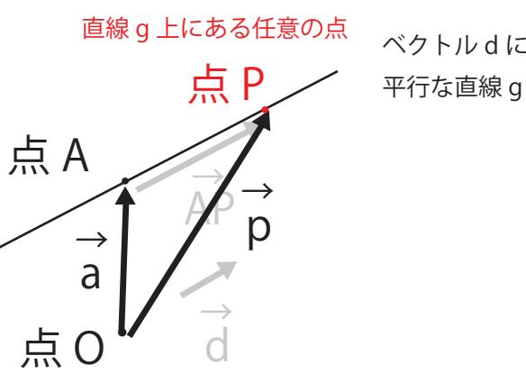
点  $A(\vec{a})$  を通り、0 でないベクトル  $\vec{d}$  に平行な直線ベクトル方程式の求め方
