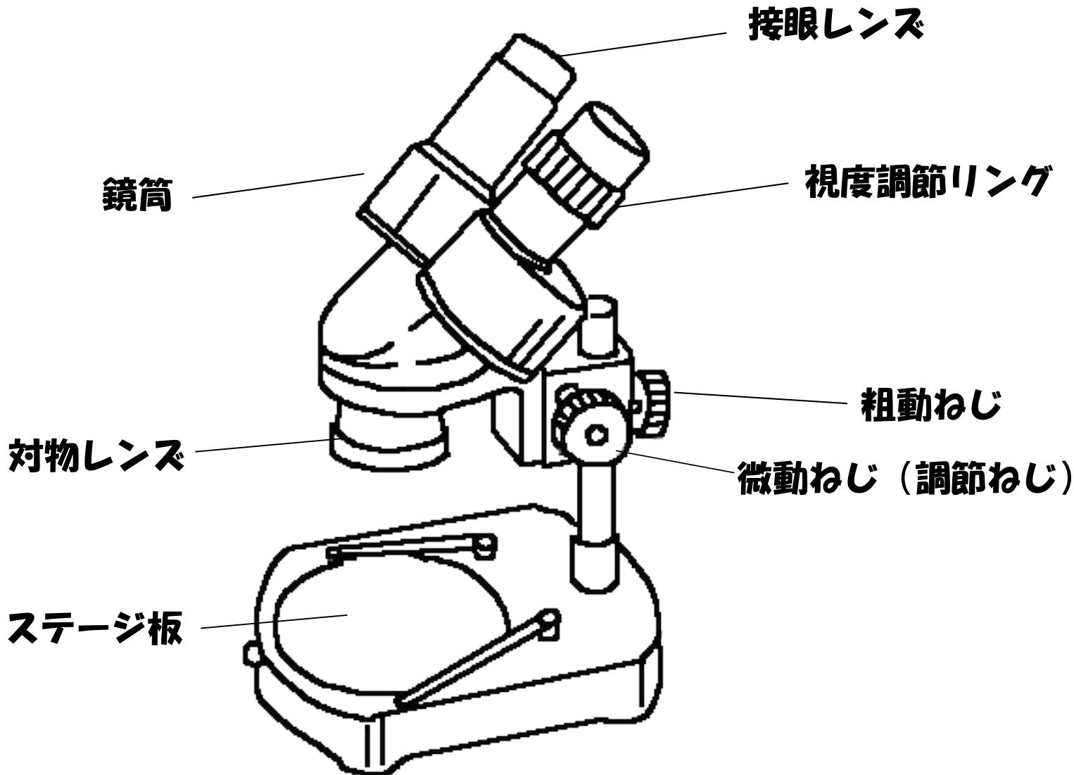
両目の間に合うよう鏡筒を調節し左右の視野が重なって1つに見えるようにする。
